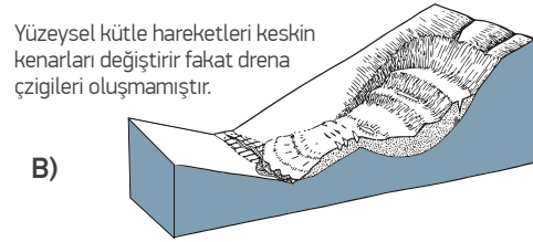
Şekil 3.9. Kurak veya yarı kurak iklim için zamana ve iklime bağlı olarak jeomorfolojik değişimleri gösteren blok diyagram. A: Heyelan hatları keskin ve belirgin olan "aktif heyelan", B: Heyelan hatları belirgin ancak keskin olmayan "hareketsiz-geç heyelan", C: Heyelan hatları yüzey drenajı, iç erozyon ve birikme ve bitki örtüsü tarafından değiştirilmiş "hareketsiz-olgun heyelan", D: Heyelan hatları belirsiz/zayıf ve genelde yanıtıcı olan "hareketsiz-yaşlı heyelan" (Soeters ve Van Westen, 1996)
