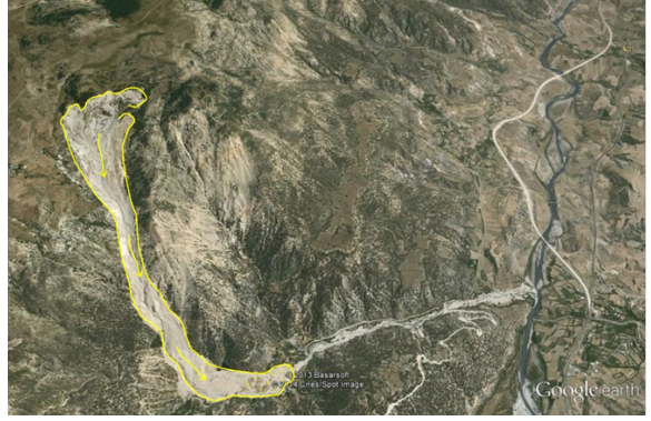
Şekil 3.7. Koyulhisar'ın kuzeyinde yer alan heyelanın genel görünümü (bakış kuzeybatıya).
