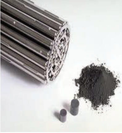
Şekil 3. Nükleer Güç Santrallerinde kullanılan nükleer yakıt (uranyum dioksit ( UO_2 ))
